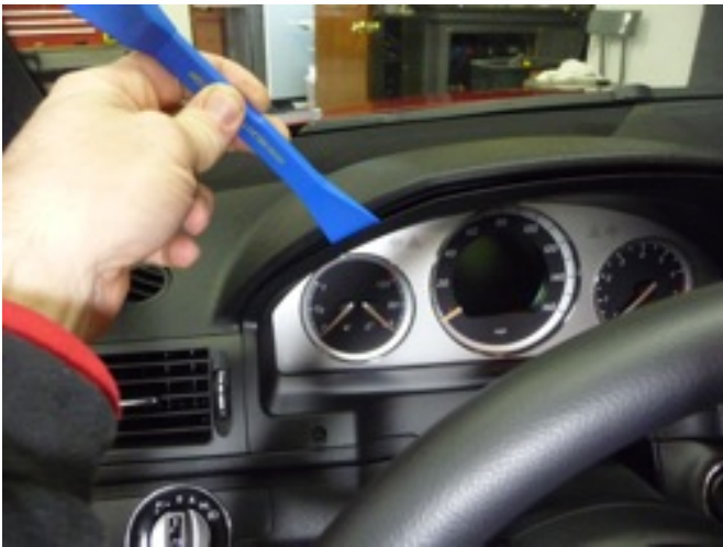
Unclip top left edge of bezel
