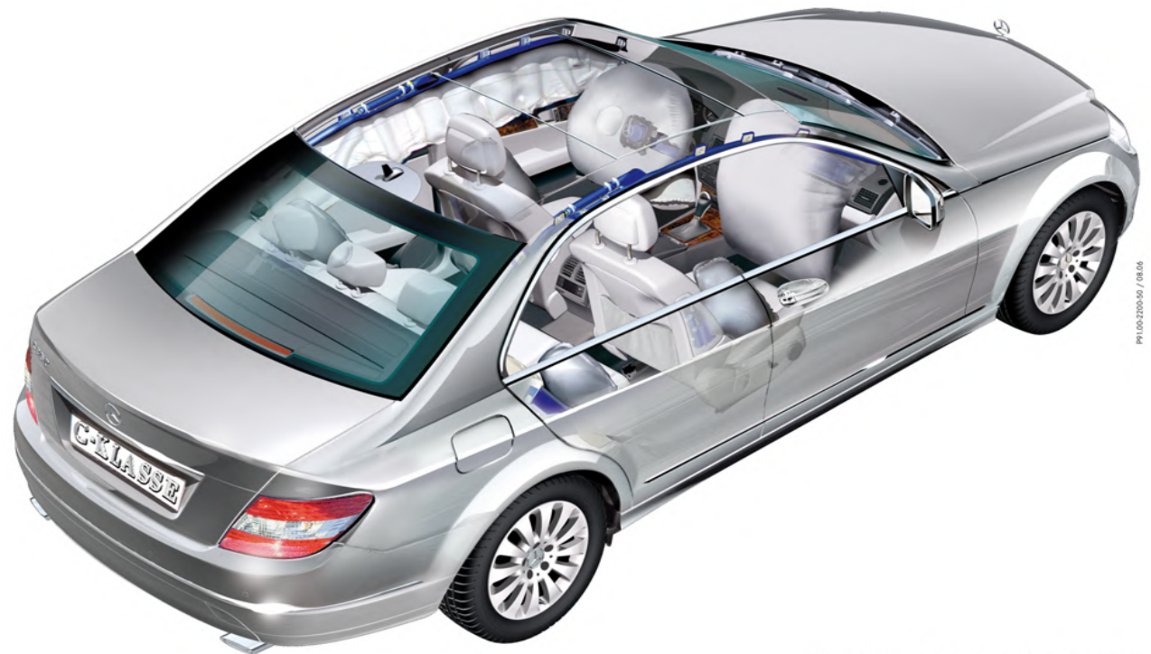
Airbag-System im Fahrzeug (Vollausstattung) C-Klasse (BR204)
