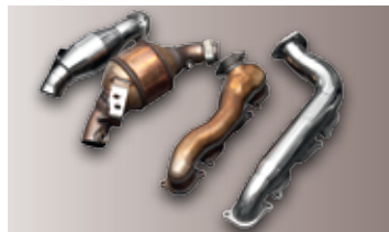
Racerkatalysator og udstødningsmanifolde. Kleemann-stumperne ligger yderst
