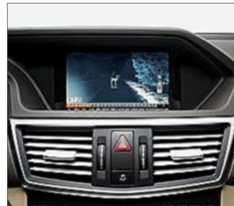
De nachtzichtassistent geeft het gebied dat het grootlicht bestrijkt in grijsstenen weer op het centrale display.
