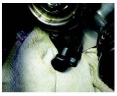
Einpresswerkzeug W276 589 00 33 00 in den Befestigungsbohrungen für den Kettenspanner verschrauben. Drehmoment 5 Nm
