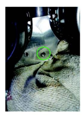
Nach Demontage des Einpresswerkzeugs prüfen ob das Rückschlagventil bündig mit der Zylinderkopffläche abschließt.
