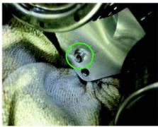
Rückschlagventil leicht beölen und bis zum Anschlag in die Ölbohrung einschieben (Geschlossene Seite mit Kugel zeigt nach hinten, die offene Seite mit Gewinde nach vorn).
