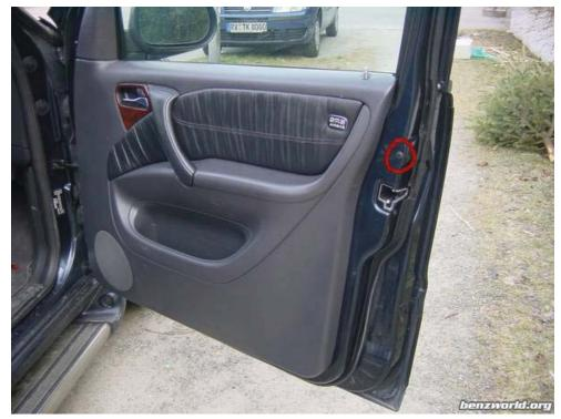
IT'S THE LITTLE RUBBER GROMIT THAT COVERS THE HOLE IN THE DOOR FOR THE HEX KEY (TO REMOVE THE OUTSIDE DOOR HANDLE)
