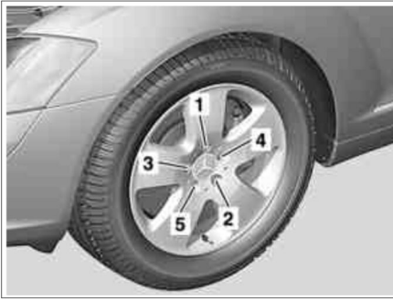
Left illustration 1 bis 5 Tightening sequence
